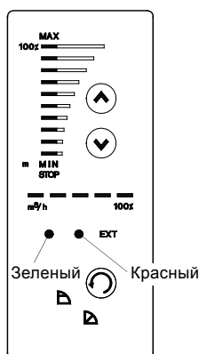
Рис. 42 Световые индикаторы на насосах с трёхфазными электродвигателями
